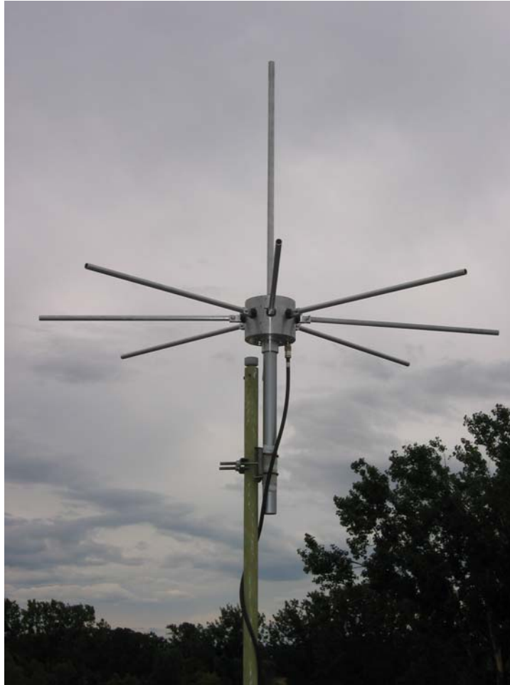
Rys. 1. Antena do pomiaru natężenia pola fal radiowych w polaryzacjach pionowej i poziomej w zakresie UKF-FM
