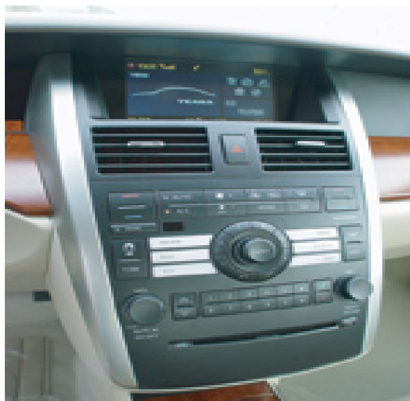
Rys. 3. Przykład zintegrowanego samochodowego wyposażenia telematycznego (OBU) Funkcje: cel i trasa, sygnalizacja poważnych wstrząsów i kradzieżowa, informacja holownicza, bytowa (posiłki, zakwaterowanie, zakupy, rozrywka, lokalne ciekawostki i krajobrazy), uwierzytelnienie haseł transakcji finansowych.
