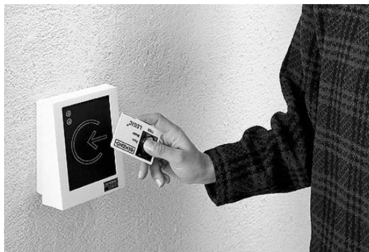
Rys. 4 Praktyczne zastosowanie czytnika RFID i bezprzewodowa karty inteligentnej (źródło: [2])
