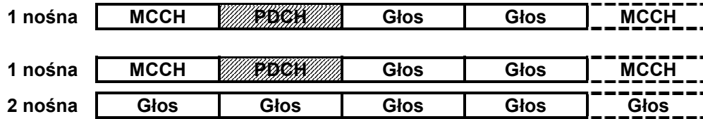
Rys. 1a: Transmisja BS z jednym dedykowanym kanałem danych (PDCH)
