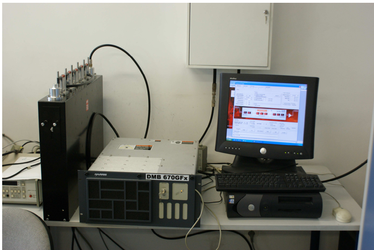
Fot. 1 Nadajnik DAB+ testowej emisji we Wrocławiu, Instytut Łączności
