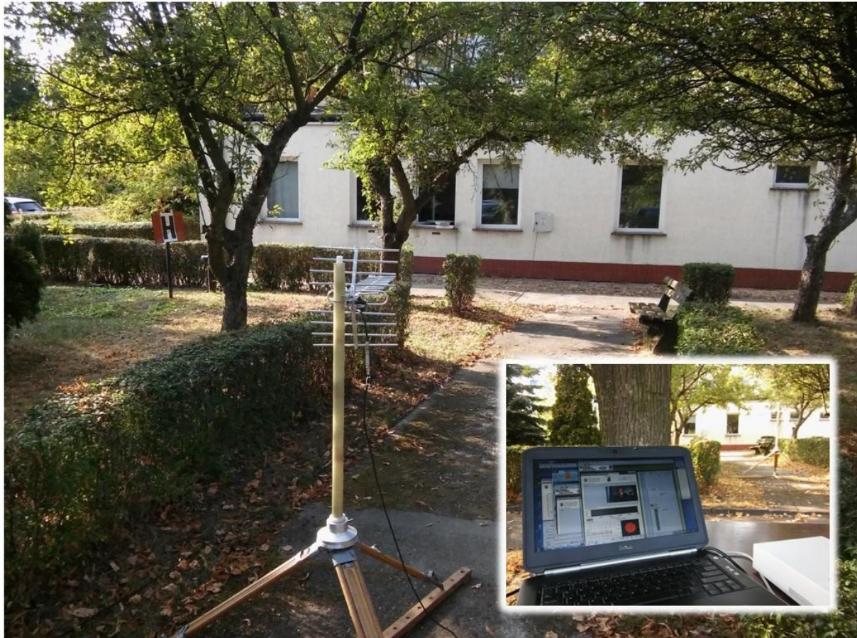
Rys. 5.5. Przykład zestawienia kanału transmisyjnego przy pomocy urządzeń USRP
