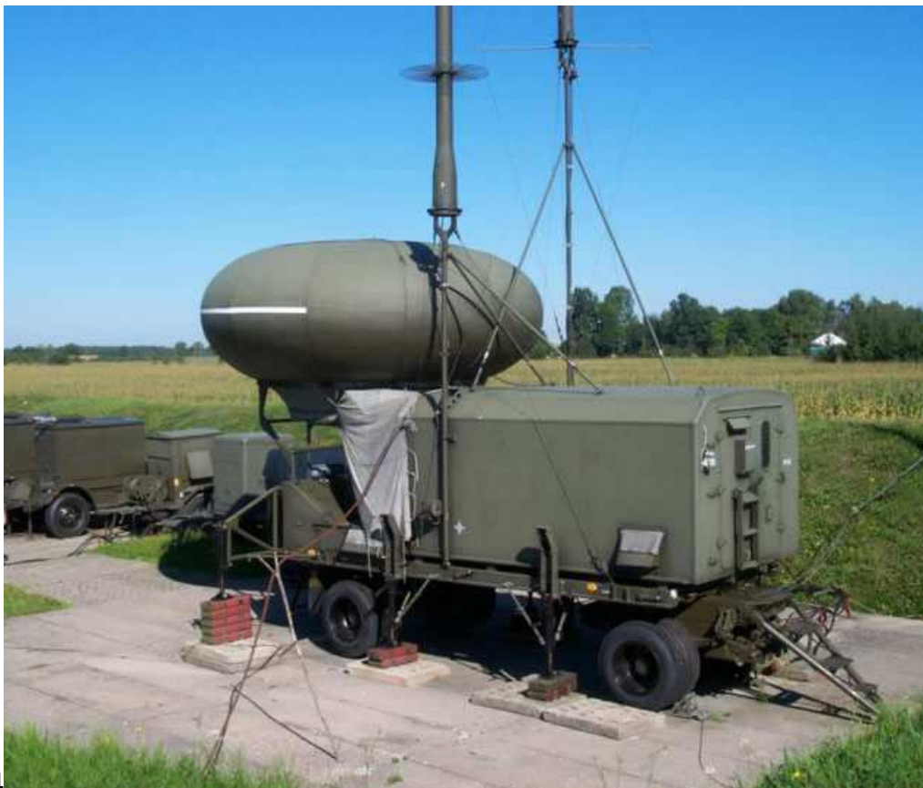
Rys. 4-9: Naziemna stacja systemu RSBN-4N (PCBH-4H)
