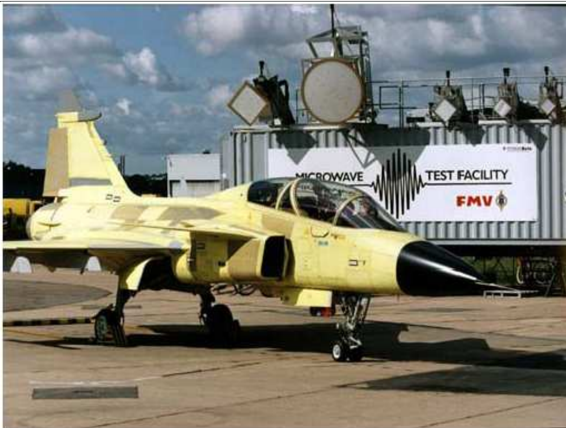
Rysunek 19. Widok stanowiska pomiarowego do badania odporności aparatury elektronicznej zainstalowanej w samolocie na narażenia elektromagnetyczne o dużej energii (Szwecja)
