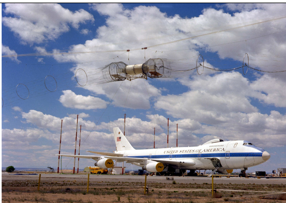
Rysunek 20. Widok stanowiska pomiarowego do badania odporności aparatury elektronicznej zainstalowanej w samolocie na narażenia elektromagnetyczne o dużej energii. Przedmiot widoczny nad samolotem wraz z siecią drutów, to generator narażeń. Źródła energii, aparatura pomiarowa i kontrolna nie są pokazane. (Źródło: http://en.wikipedia.org/wiki/Electromagnetic_pulse (4.10.2009))
