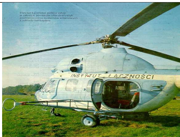
Rysunek 14. Mobilny generator impulsu elektromagnetycznego o dużej energii. Z prawej strony szkic generatora amerykańskiego (wg: Degauque P, Hamelin J: Electromagnetic Compatibility, ISBN 0-19-856375-2, str. 571). Z prawej strony śmigłowiec Instytutu Łączności przewidywany do przenoszenia takiego generatora. Element z lewej strony kadłuba to generator narażeń o niewielkiej energii (źródło: Strużak R, Żernicki E: Latające Laboratorium Instytutu łączności; Przegląd Telekomunikacyjny , 1981, Nr 9/10, p.258-262).
