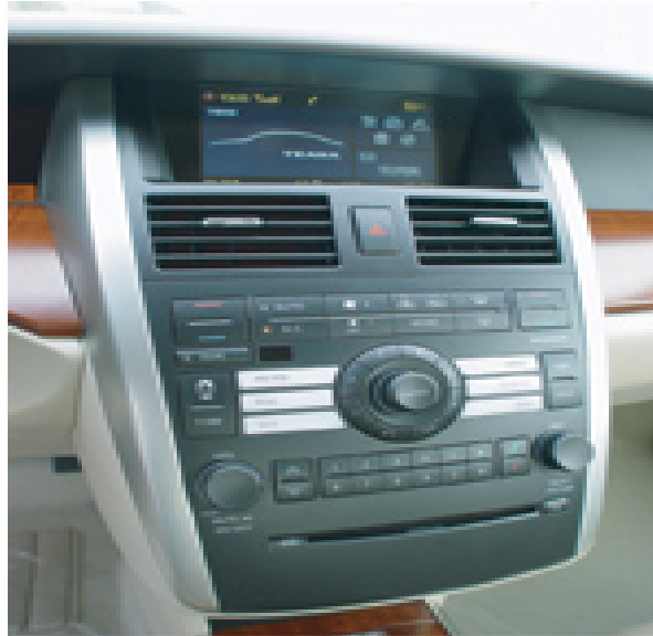
Rys. 3. Przykład zintegrowanego samochodowego wyposażenia telematycznego (OBU) Funkcje: cel i trasa, sygnalizacja poważnych wstrząsów i kradzieżowa, informacja holownicza, bytowa (posiłki, zakwaterowanie, zakupy, rozrywka, lokalne ciekawostki i krajobrazy), uwierzytelnienie haseł transakcji finansowych.
