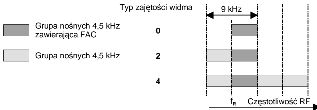
Rys. 4.3: Widmo zajmowane przez sygnał DRM w kanałach o szerokości 9 kHz
