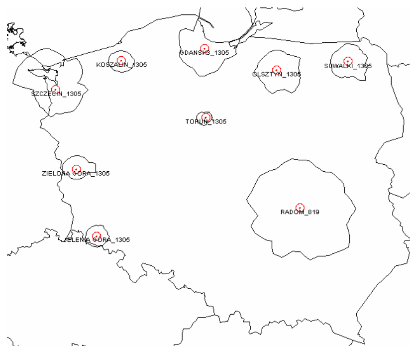
Rys. 4.14: Analiza zasięgów stacji multiplexu 3A z użyciem programu AnaZas – moce oszacowane
