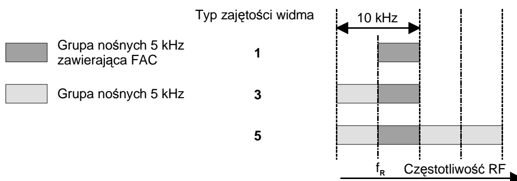
Rys. 4.4:: Widmo zajmowane przez sygnał DRM w kanałach o szerokości 10 kHz
