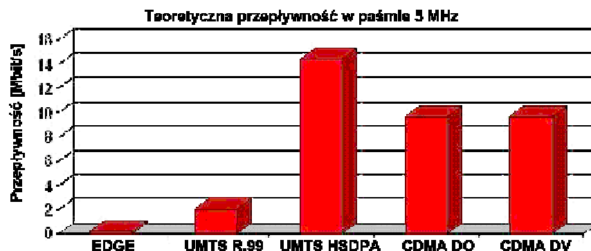
Rys. 6: Teoretyczna przepływność w odniesieniu do pasma 5 MHz
